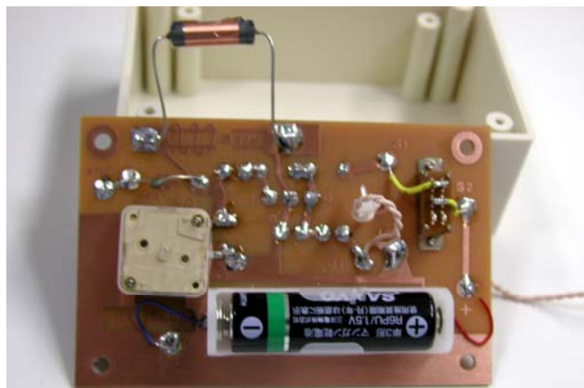
▲本機の外観とハンダ面。コイルやコンデンサー等一部はパターン面に付けます
